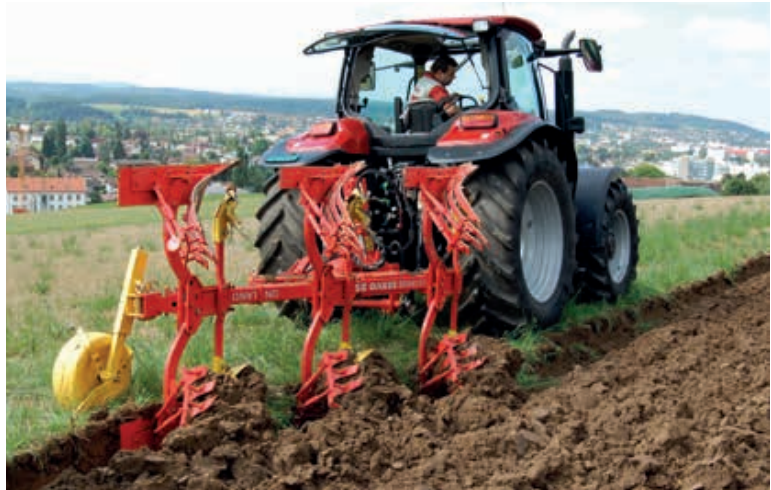
Mit dem Onlandpflug kann außerhalb der Furche gefahren werden. Der noch nicht umgebrochene Boden erleidet weniger Befahrungsschäden. Schlupf und die Bildung einer Pflugschle können vermieden werden. Aber auch beim Onlandpflug gelten die üblichen Praxisregeln zur Vermeidung von Bodenverdichtungen.
